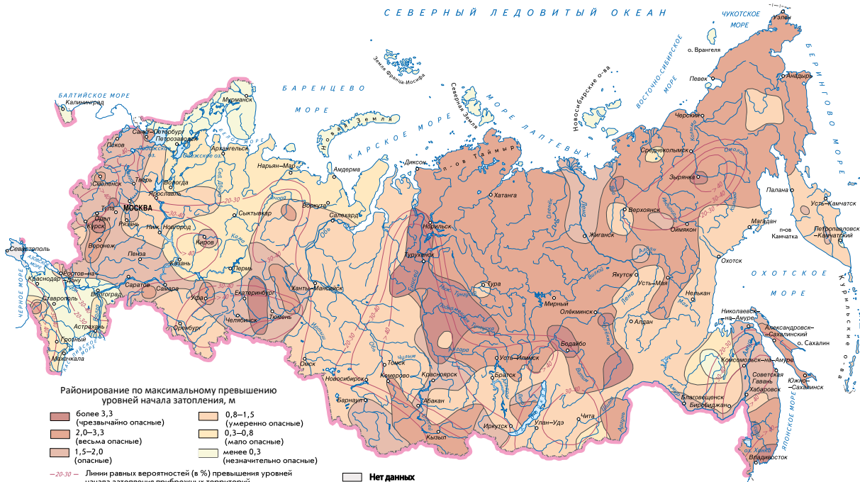
Рис. 3.11. Районирование по опасности затопления, м
